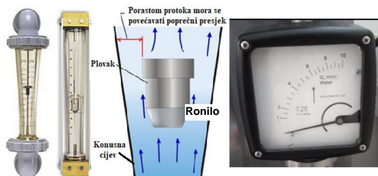
Slika 3 Različite izvedbe rotametra i prikaz strujanja u rotametri
